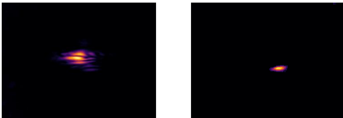
Рис. 1. Экспериментальная оптимизация волнового фронта лазерного излучения: распределение интенсивности до (слева) и после (справа) оптимизации.
