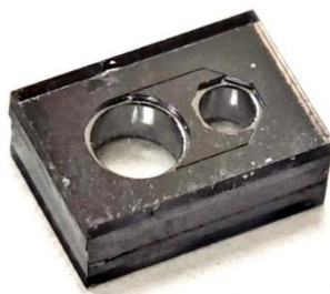
Рис.1 Газонаполненная ячейка квантового стандарта частоты, созданная по МЭМС технологиям.
