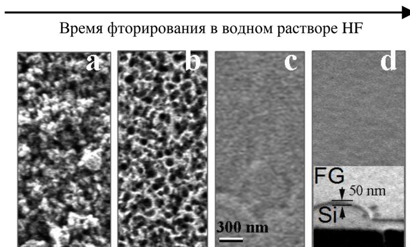
Рис. 5. Изображения поверхности пленок для разного времени фторирования, полученные методом сканирующей электронной микроскопии. Масштаб на рисунках одинаковый, а – исходный вид поверхности нефторированных пленок, b – поверхность пленок после 2 дней фторирования, c – после 10 дней, d – после 40 дней. На вставке рис. d показано изображение края пленки, снятое под углом  $45^\circ$  к поверхности, FG – фторографен, Si - кремний.
