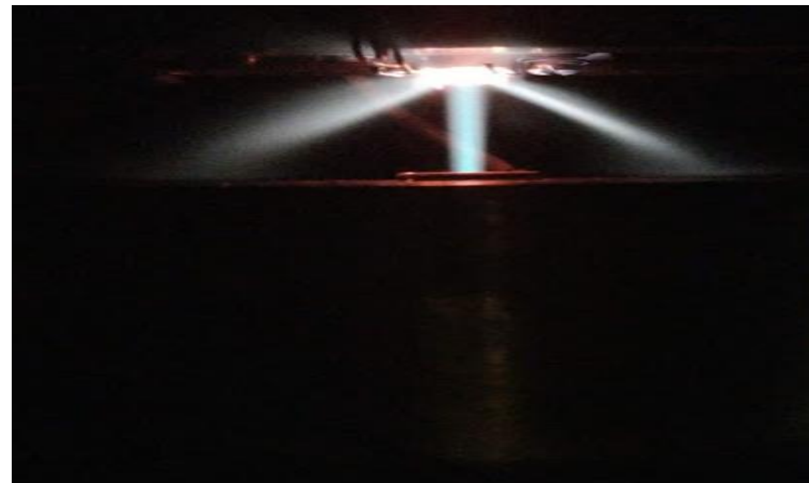
Fig 2. Иллюстрация работы установки по напылению алмазной пленки на подложку из кремния
