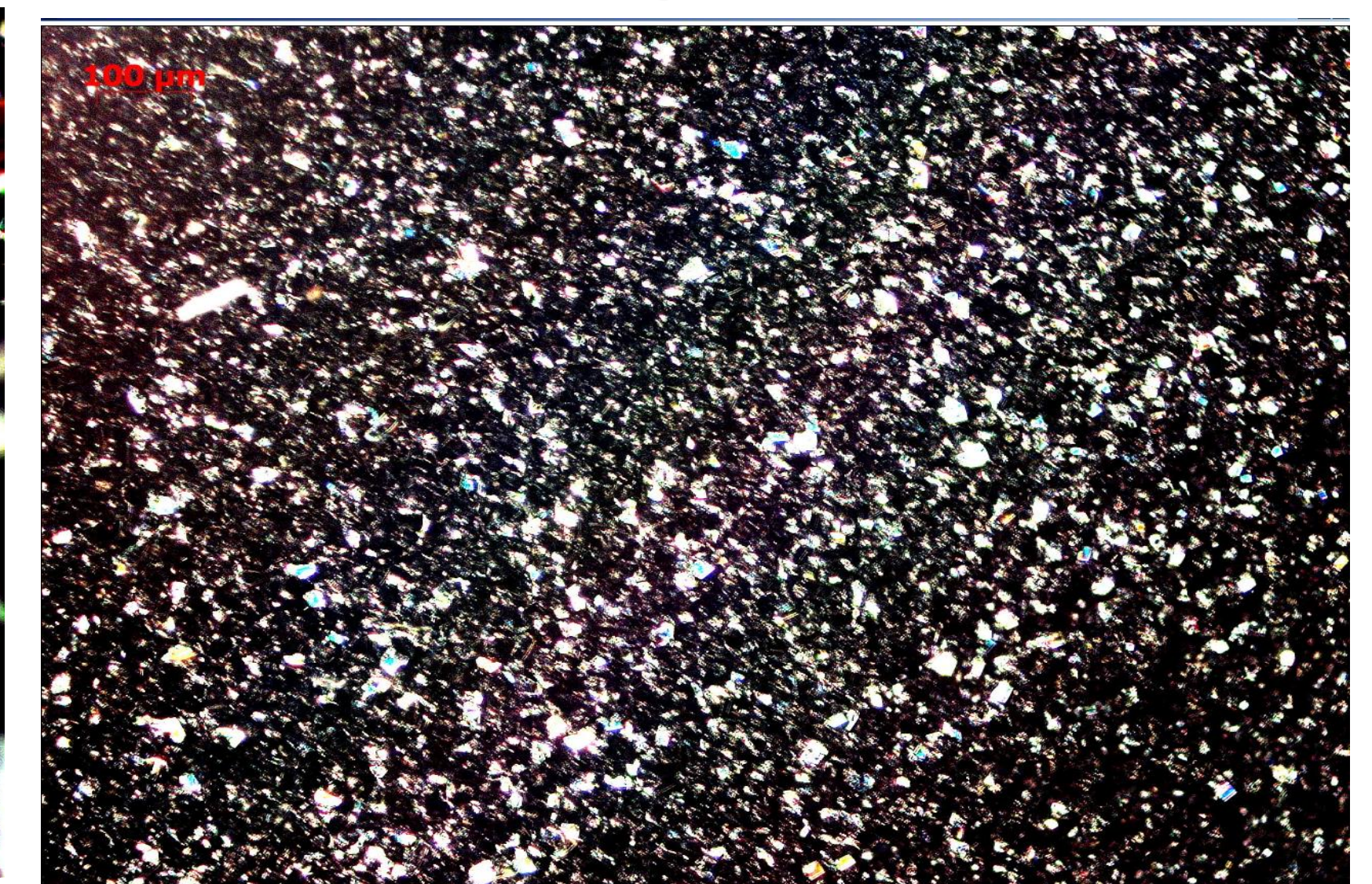
Fig 9. Вид пленки алмаза на карбиде кремния с разрешением 100 мкм
