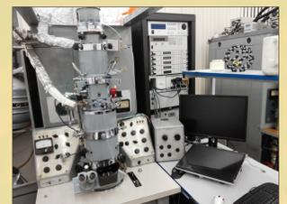
Сверхвысоковакуумный отражательный электронный микроскоп (СВВ ОЭМ) на базе JEM-7A
